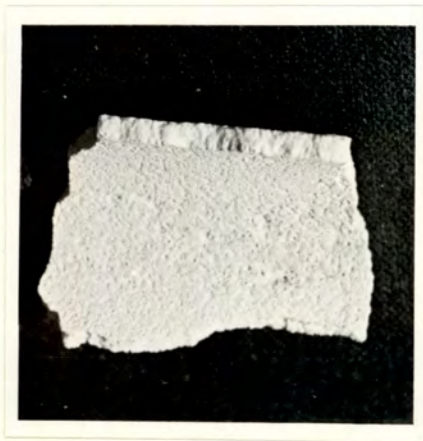
UNDERSIDE (TUBE SIDE) AND EDGE OF SCALE SAMPLE
