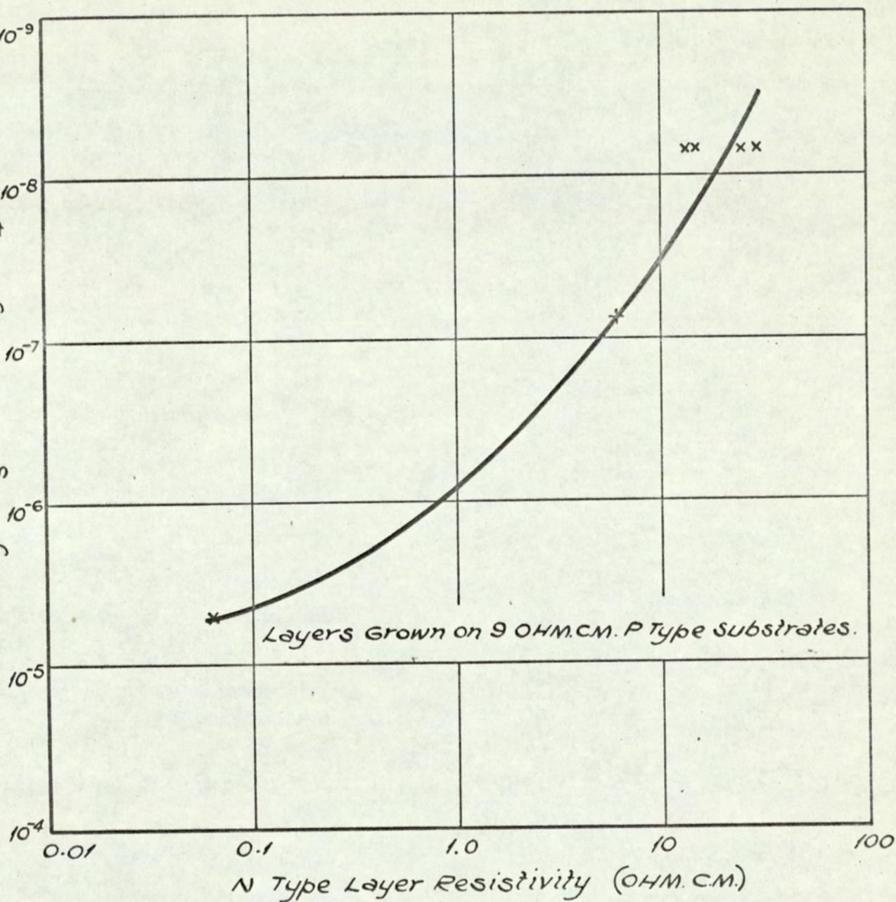
5.5.25. RELATIONSHIP OF THE CONCENTRATION OF  $PCL_3$  IN  $SiCl_4$  TO THE N TYPE LAYER RESISTIVITY.
