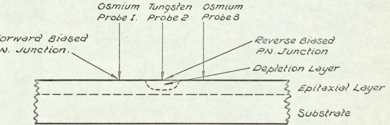
FIG.4.9 3 POINT PROBE SYSTEM.
