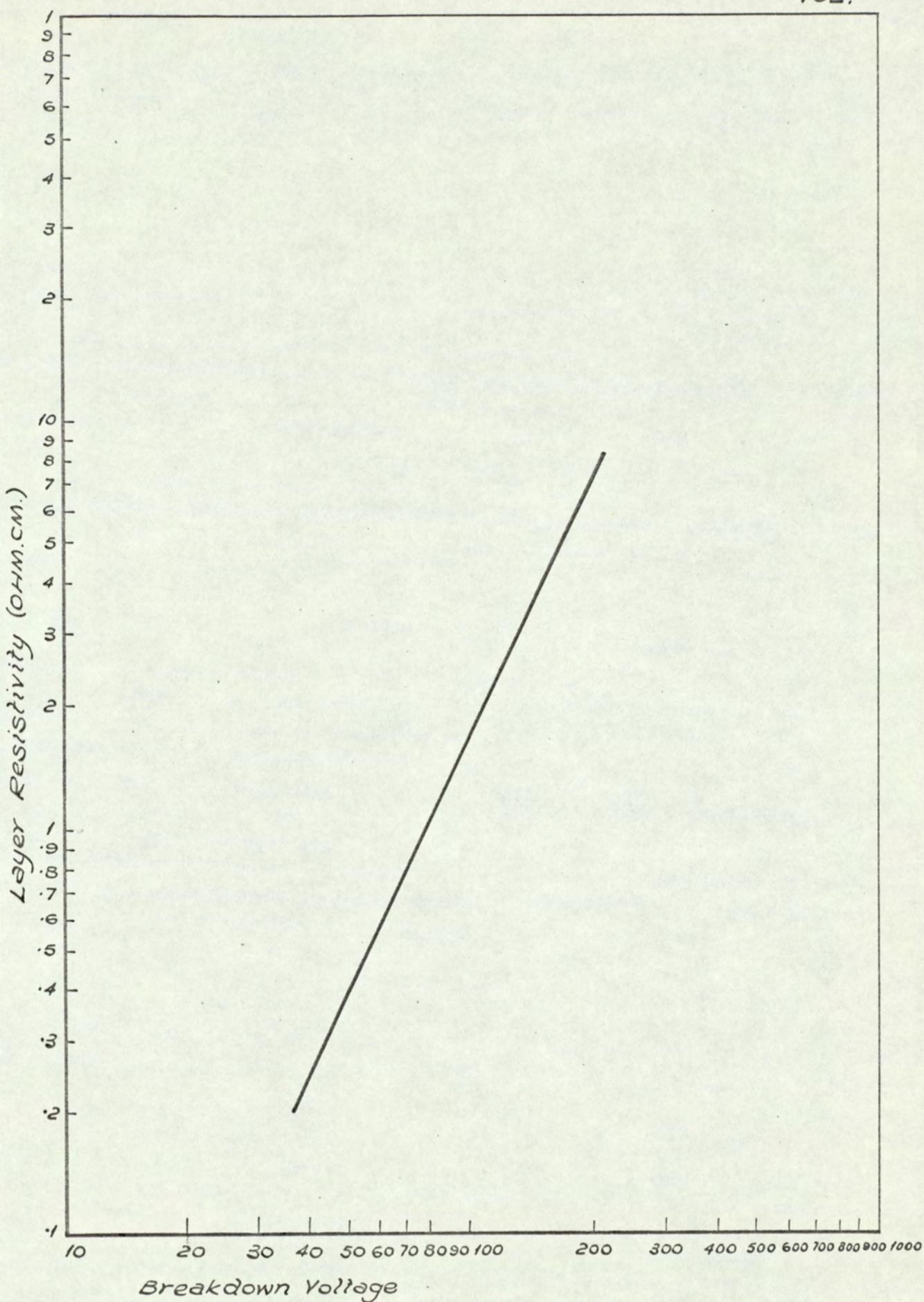
FIG. 4.12. BREAKDOWN VOLTAGE-LAYER RESISTIVITY CALIBRATION FOR THREE POINT PROBE.
