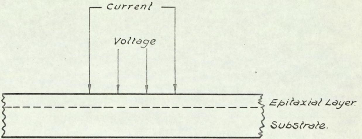
FIG.4.8 4 POINT PROBE SYSTEM.
