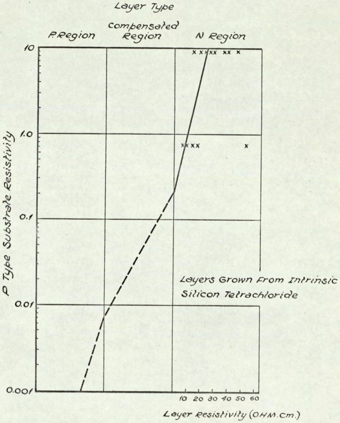
FIG. 5.23. EFFECT OF P TYPE SUBSTRATE RESISTIVITY ON THE LAYER TYPE & RESISTIVITY GROWN FROM INTRINSIC SILICON TETRACHLORIDE.
