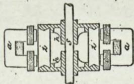
FIG. 4.—MOOREY'S INDUCTOR ALTERNATOR.
