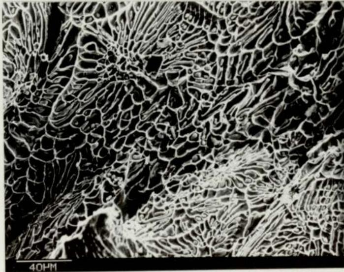
PLATE 67 : DUCTILE FRACTURE SURFACE OF STEEL
