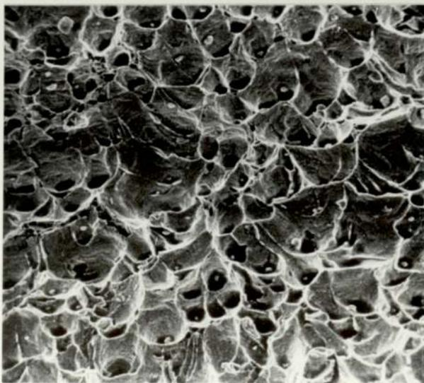
PLATE 66A : DUCTILE FRACTURE
