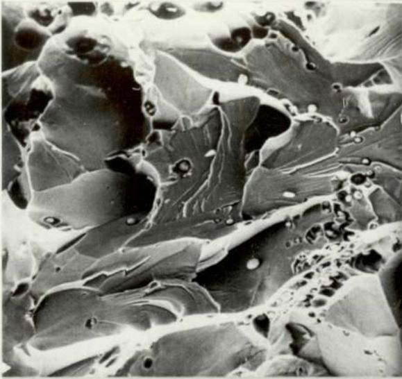
PLATE 65A : CLEAVAGE FRACTURE
