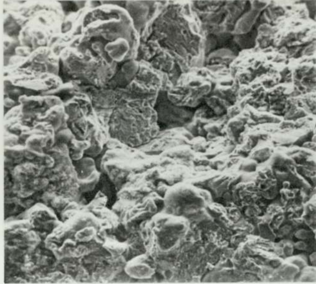
a) General fatigue fracture; density 5.95 \text{ Mgm. m}^{-3} , as-sintered, (x 1000)
