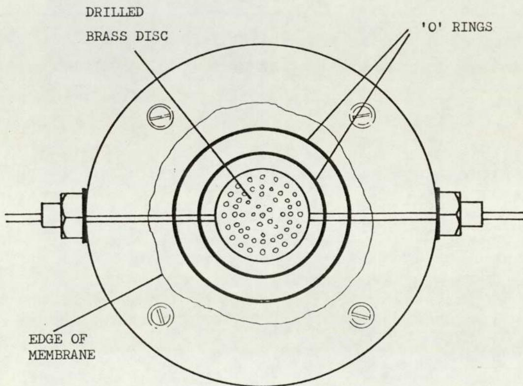
FIGURE 9 : Diffusion membrane test cell
