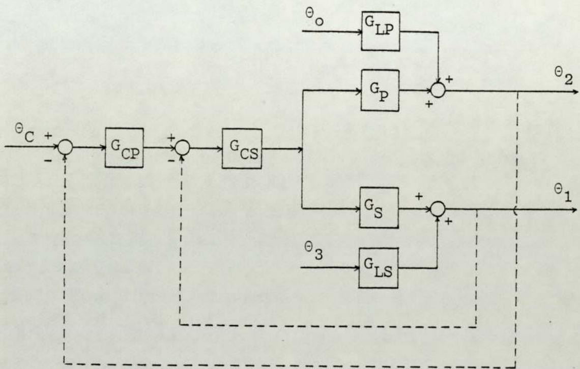
Fig. 2.2 BLOCKDIAGRAM OF A PARALLEL CASCADE CONTROL SYSTEM
