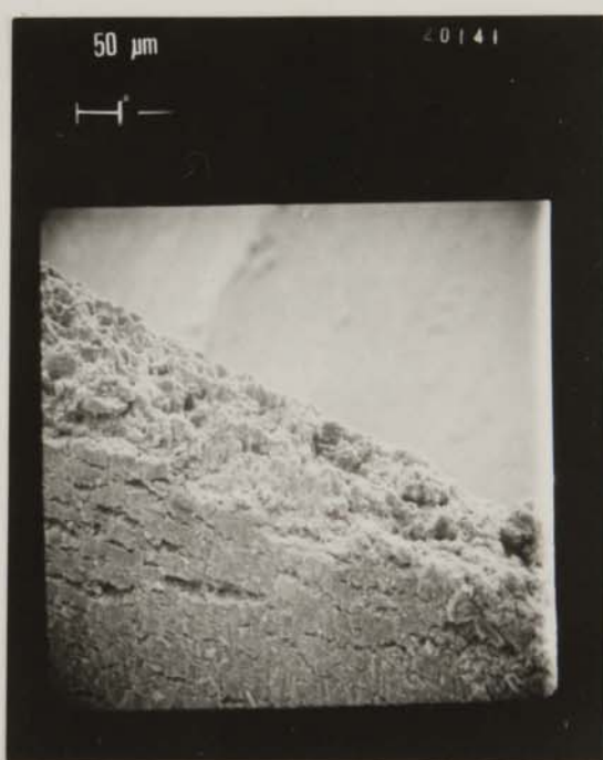
(d) Unirradiated, \sigma_{\text{Nett}} = 62.3 \text{ MNm}^{-2}
